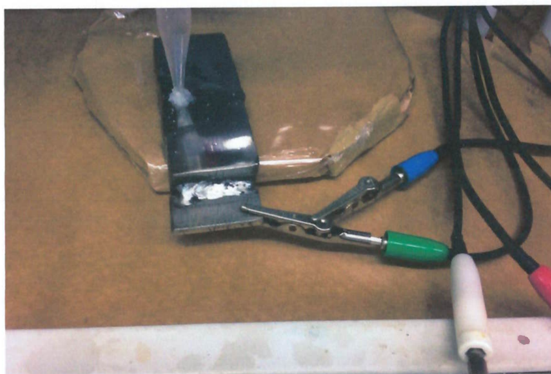
Figura 4-15: Detalhe mostrando a ligação do eletrodo ao corpo de prova, a vedação de silicone e o bico de pipeta
